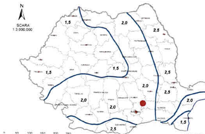
fig.3 – zonarea valorilor caracteristice din zăpadă pe sol s_k , kN/m 2 , pentru altitudini A \leq 1000 m
